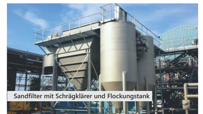
Prozesswasseraufbereitung bei der Steinverarbeitung
