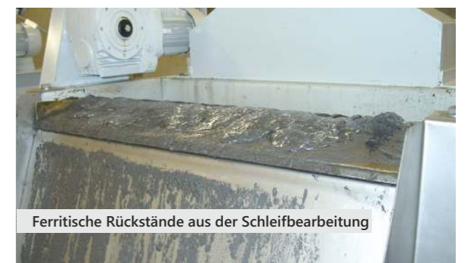
Magnetabscheider beim Schleifen von Zahnrädern
