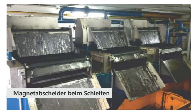
Ferritische Rückstände aus der Schleifbearbeitung
