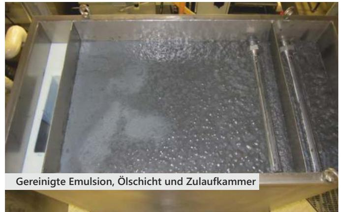
Gereinigte Emulsion, Ölschicht und Zulaufkammer
